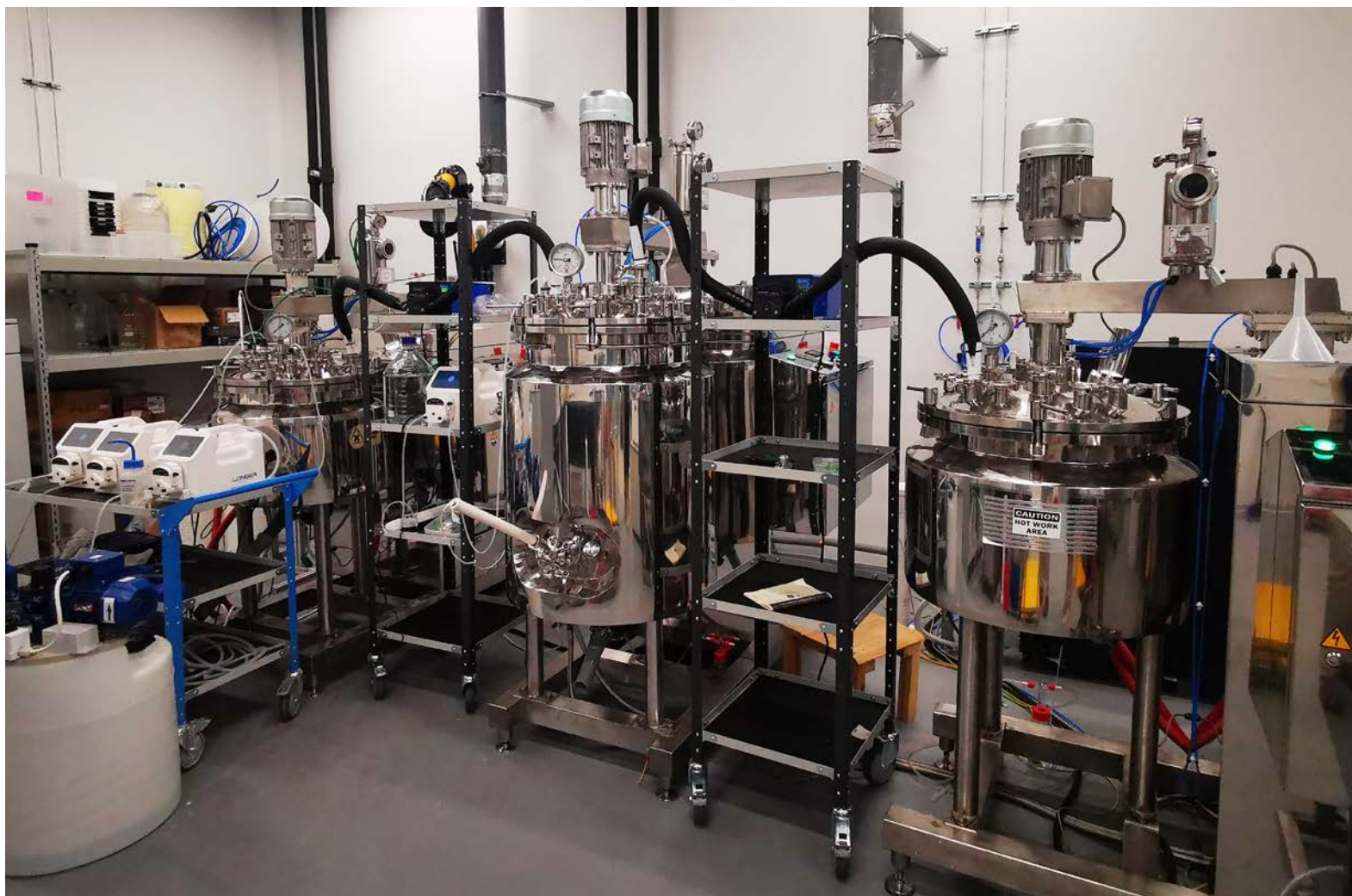
Пилотная установка непрерывного соосаждения пКАМ до 5 тонн/год, 2023*
